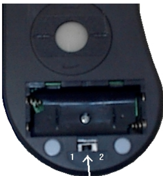
Figuur 1: Onderkant van de muis met open batterijcompartiment
