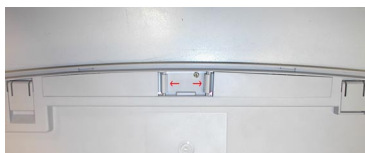
Figura 2: inserimento delle batterie
