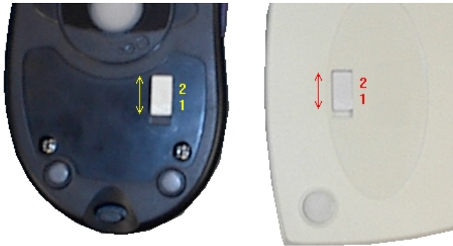
Figuur 3: onderkant van de muis (links) en de RF Receiver (rechts)
