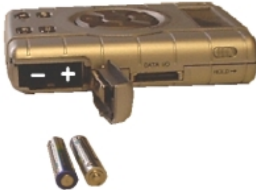
Figuur 7: Batterijen plaatsen
