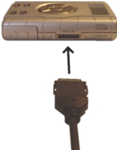
Figuur 10: Datakabel aansluiten
