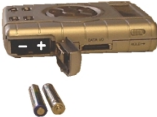
Figura 7: Colocación de las baterías
