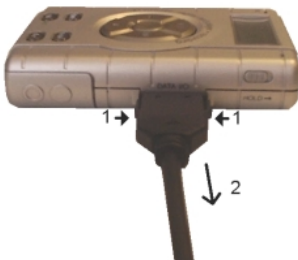
Figura 11: Desconexión del cable de datos
