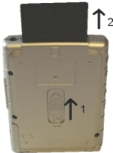
Abbildung 9: Die Speichererweiterungskarte entfernen
