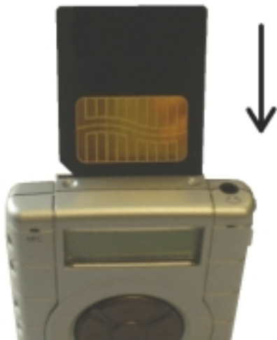
Abbildung 8: Die Speichererweiterungskarte einlegen
