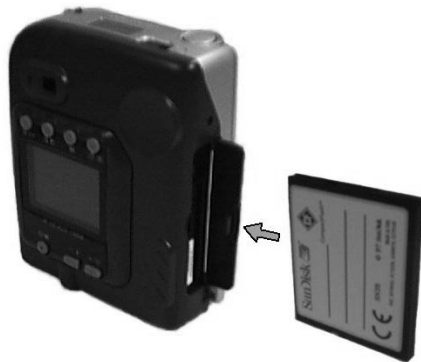
Figura 26: Utilizar la tarjeta de memoria CF
