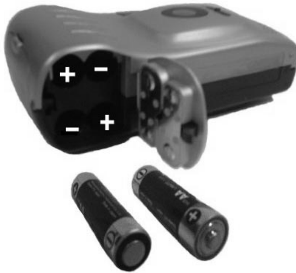
Figuur 23: Batterijen plaatsen
