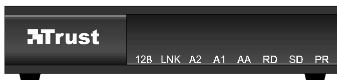
Figure 2: Face avant du Trust Communicator ISDN. Ce panneau de voyants indique si une connexion est établie et si la ligne est en ordre.
