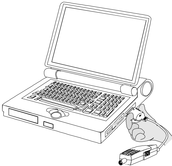
Figuur 6: Druk de ontgrendelingen in terwijl u de PSL-stekker lostrekt
