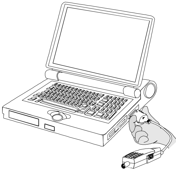
Figura 6: Apriete los ganchos al desconectar el conector PSL
